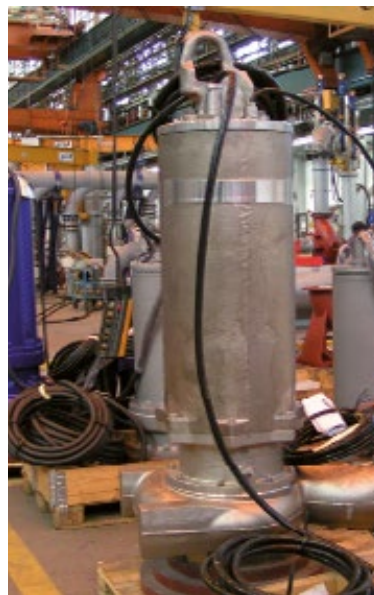
Fig. 2.4 : KRT tout en acier duplex pour application eau de mer
