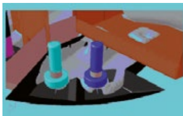
Fig. 5.11a : Écoulement du fluide dans une station de relevage KRT
