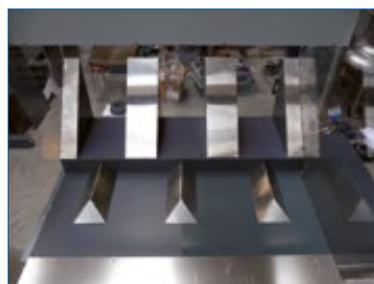
Fig. 5.4a : Réalisation d'un modèle réduit d'une station de relevage avec pentes et nervures.
