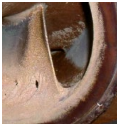
Fig. 1.5 : Roue endommagée par cavitation (source : KSB Kreiselpumpen-Lexikon).
