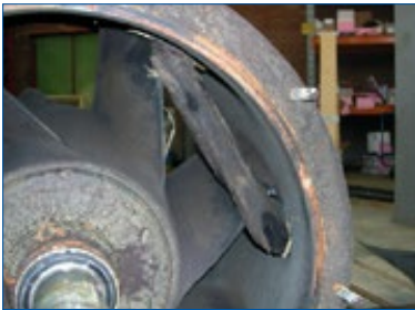
Fig. 2.7-d : Morceau de bois retenu dans le corps redresseur d'une pompe Amacan
