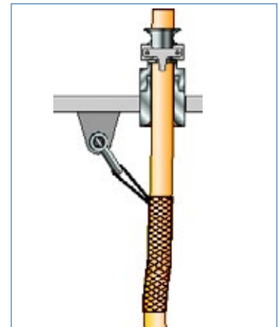
Fig. 3.3-c : Suspension de câble et passage de câble dans le tube
