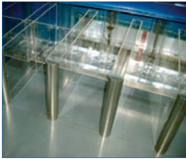
Fig. 2.5-a : Modèle acrylique d'une station de relevage Amacan P
