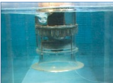
Fig 2.5-f : Prise de vue en laboratoire d'un vortex de surface type 3
