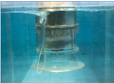
Fig. 2.5-e : Prise de vue en laboratoire d'un vortex de surface type 6
