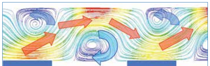
Abb. 81: Stromlinien entlang mehrerer Belüfterfelder
