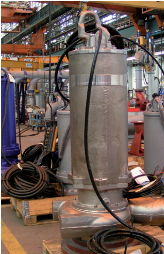
Abb. 28: Amarex KRT in Werkstoffausführung 1.4517
