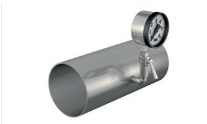
Abb. 78: Druckmessung in horizontaler Rohrleitung
