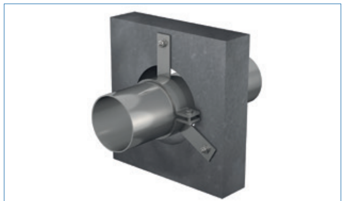
Abb. 74: Axialschubsicherung als Festpunkt
