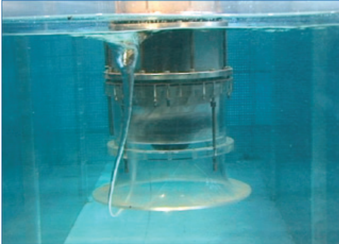
Abb. 105: Laboraufnahme eines Oberflächenwirbels Typ 6
