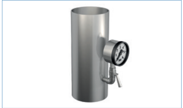
Abb. 79: Druckmessung in vertikaler Rohrleitung
