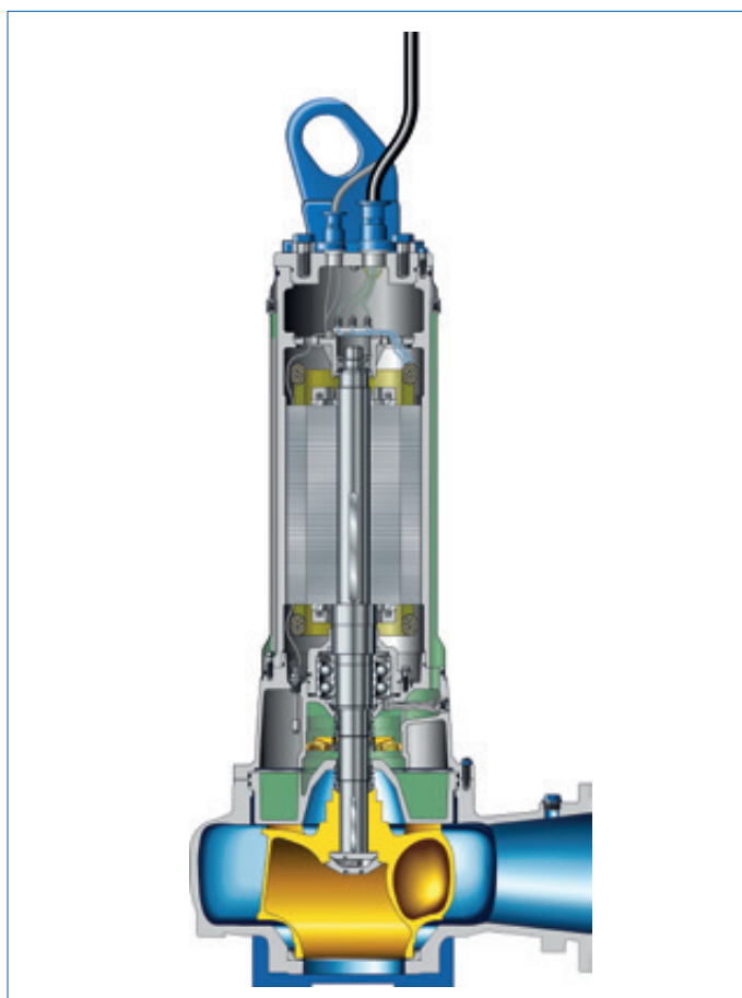
Abb. 46: Schnittbild einer KRT > 60 kW, mit Kühlmantel
