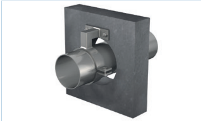
Abb. 75: Axialschubsicherung als Festpunkt
