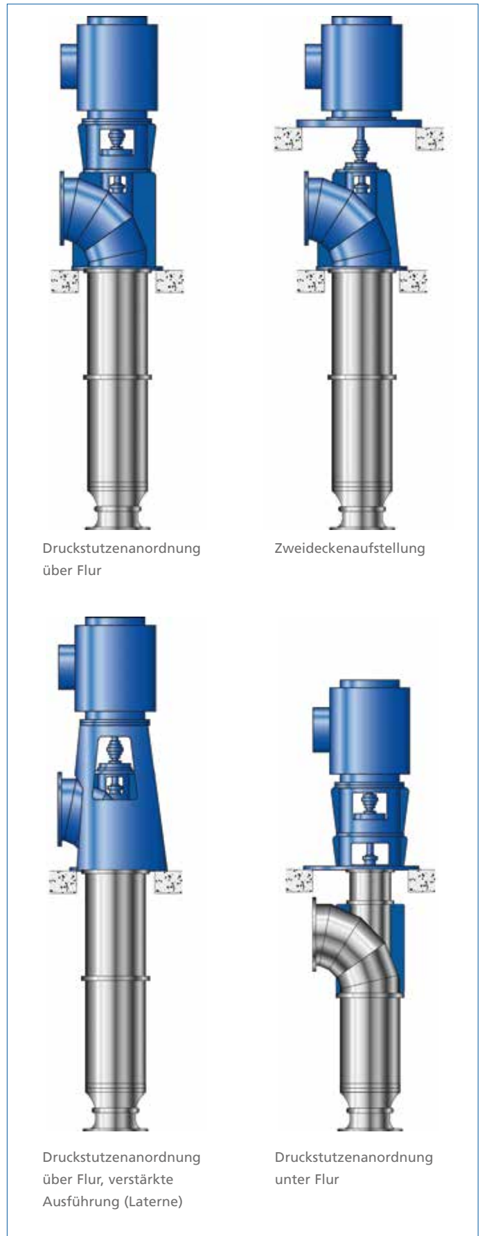
Abb. 2: Aufstellungsarten der Rohrgehäusepumpe
