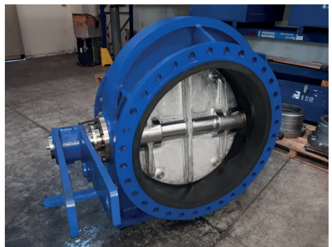
Revisione completa con costruzione di lente e alberi, rivestimento del corpo vulcanizzato e verniciatura finale
