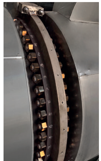
Anello in acciaio per flange con diametro 1600 mm che lavorano a 700 °C e 10 bar
